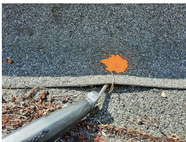
Obr. /18/ Separace tavných spojů
