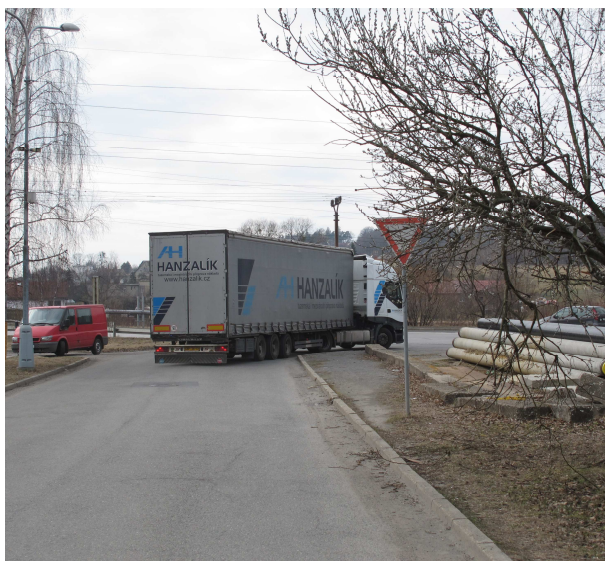
Obrázek 16.11: Křižovatka K24, značka P04 „dej přednost v jízdě“ je na ulici Collo-louky zakryta v letním období listy ze stromu (vlevo), do křižovatky je nevhodně zaústěna účelová komunikace (vpravo).
