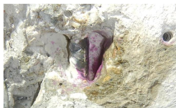
detail výztuže a zkouška karbonatace
