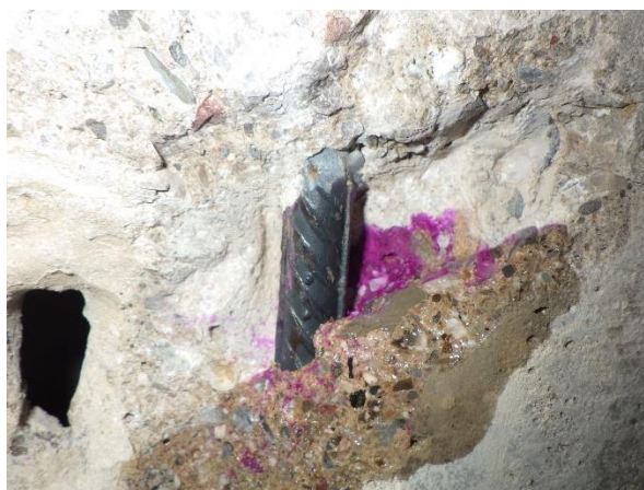
Foto č. 99 - 100 – sonda NV14 – strop z žb panelů, detail výztuže
