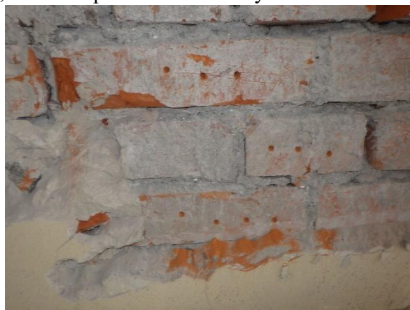
Foto č. 49 - 52 – sonda NS 25 – celkový pohled , detail provedené zkoušky
