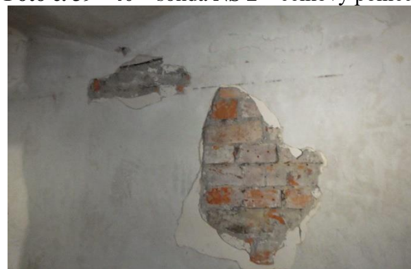
Foto č. 39 - 40 – sonda NS 2 – celkový pohled , detail provedené zkoušky
